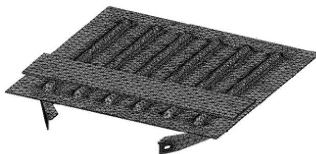
Рис. 7. Скінчено-елементна модель кришки люка
